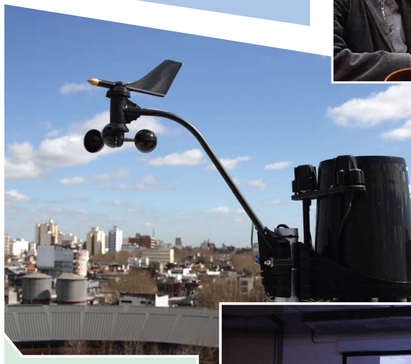
ESTACIÓN METEOROLÓGICA AUTOMÁTICA La EMA mide temperatura, presión, humedad, sensación térmica, viento, lluvia y radiación solar. Instalada en la terraza del nuevo edificio del 31A, tiene una plantilla web donde se puede consultar el pronóstico local actualizado cada 15 minutos.
